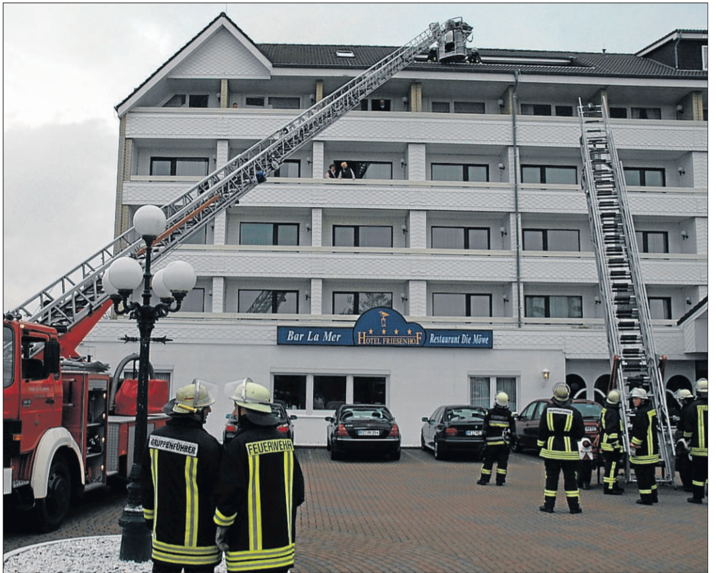
Übung 2005 im Friesenhof: Die geforderte automatische Drehleiter (links) reicht bis zum Dach, die alte Anhängerleiter der Büsumer Feuerwehr wäre selbst ausgefahren noch zu kurz. Sie dient zudem nur als Hilfsmittel für Löscharbeiten. Personen dürfen über sie nicht gerettet werden. Archivbild: Böge
